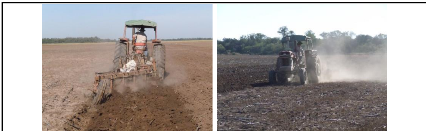
Laboreo con arado de rejas para siembra de girasol en convencional. Charata, Chaco. 25 04 13
